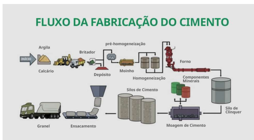
Figura 3 - Fluxograma do processo de fabricação do Cimento Portland por via seca (Cimentos Mauá, 2019).
